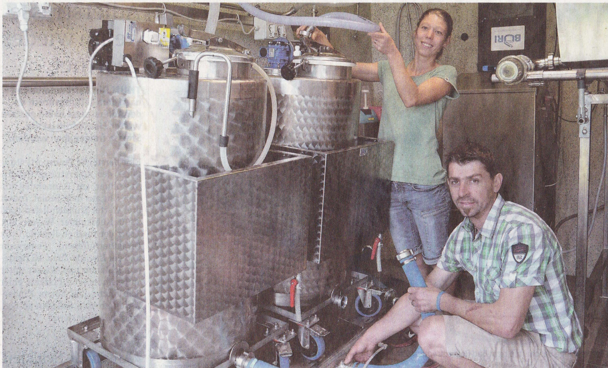
Evelyne und Hansruedi Peter zeigen die Pasteurisieranlage auf ihrem Hof in Steffisburg. Die frische Milch kommt in den grossen Tanks in den Automaten.
